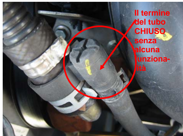
Picture 7: Terminale (chiuso) del tubo.
