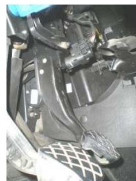
**ATTENZIONE:** L'interruttore potrà essere testato elettricamente esclusivamente a seguito del montaggio e rotazione nell'apposita sede, in quanto l'articolo viene fornito nella posizione "contatto inattivo".
