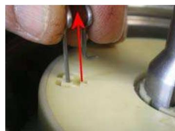
10) Rimontare il canotto, la guarnizione e l'anello elastico.
