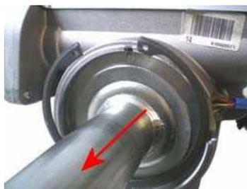
4) Allineare con cura i segni di riferimento, ruotando l'alberino quanto necessario. Togliere il sensore agendo nella parte inferiore con cacciavite o attrezzo analogo.
