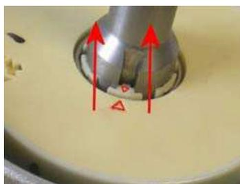
5) Prestare molta attenzione al nuovo sensore: la molletta di fermo deve essere perfettamente ortogonale alla struttura plastica in maniera da rendere solidali entrambi i "dischi" del sensore.
