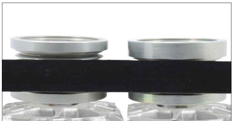
Figura 1: a sinistra, ruota libera alternatore INA 535 0202 10 a 6 scanalature - a destra, ruota libera alternatore a 5 scanalature
