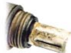
Contaminazione da fluido refrigerante
