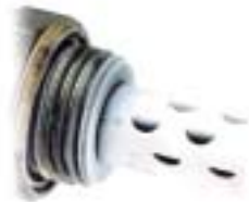
Contaminazione da silicone
