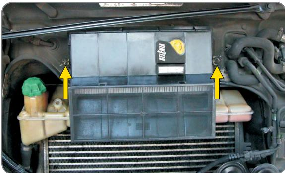
**PL** Odpiąć klipsy zabezpieczające obudowy filtra
