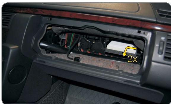
**PL** Ostrożnie usunąć zabrudzone filtry, następnie zamontować nowe oraz wykonać powyższe czynności w kolejności odwrotnej
