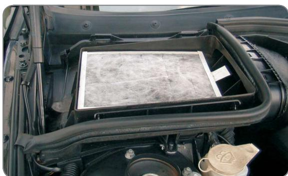
**PL** Wyciągnąć z gniazda zabrudzony filtr, zamontować nowy, zamknąć pokrywę oraz zabezpieczyć zaczepem, czynności wykonać dla obu filtrów
