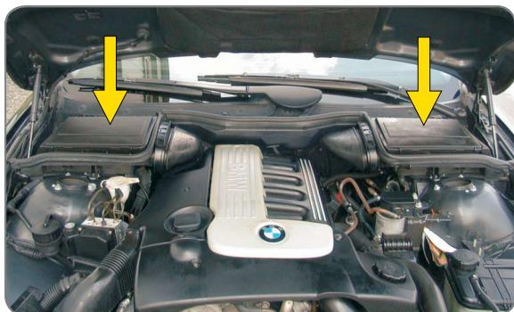
**PL** Podnieś maskę przednią, filtry przeciwpłykowe znajdują się w symetrycznie rozmieszczonych prostokątnych obudowach
