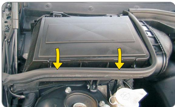
**PL** Odpiąć zaczep mocujący, wyjąć pokrywę filtra
