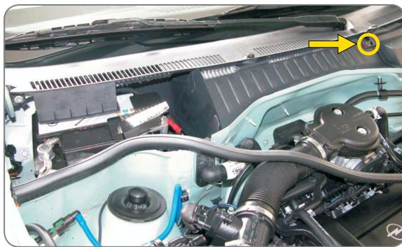
**PL** Odkręcić wkręty pokrywy filtra, usunąć pokrywę
