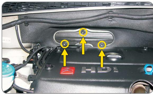
**PL** Odkręcić wkręty pokrywy filtra, usunąć pokrywę
