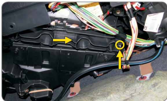
**PL** Odkręcić wkręty pokrywy filtra, usunąć pokrywę
