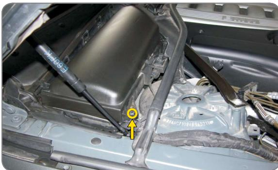
**PL** Odkręcić wkręty pokrywy filtra, usunąć pokrywę
