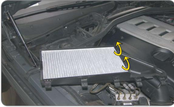
**PL** Wyciągnąć filtr z ramką, zużyty usunąć z ramki i zamontować nowy.
