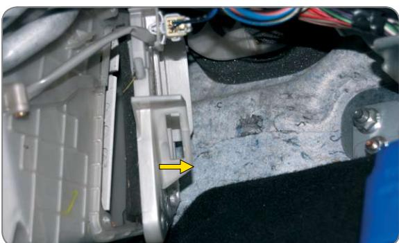
**PL** Odkręcić wkręty pokrywy filtra, usunąć pokrywę
