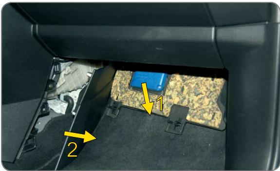
**PL** Zdemontować plastikowe osłony wg pokazanej kolejności
