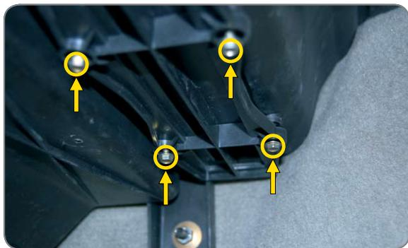
**PL** Odkręcić wkręty pokrywy filtra, usunąć pokrywę
