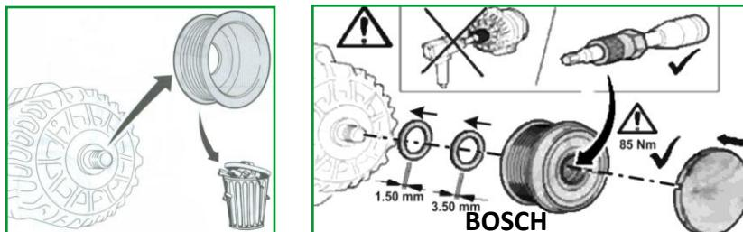
■ A főtengely szijtárcsát úgy terveztek, hogy a dobozban található generátor csúszó szijtárcsájával együtt működjön, garantálva önnel 24 hónap hasznos futásteljesítményt. Ezért szükséges és létfontosságú a főtengely szijtárcsával együtt cserélni a generátor szijtárcsát is. Ellenkező esetben a BREDA LORETT SRL nem vállal felelősséget a sérülésekért és a motorsérülésből eredő félreértésekért.
